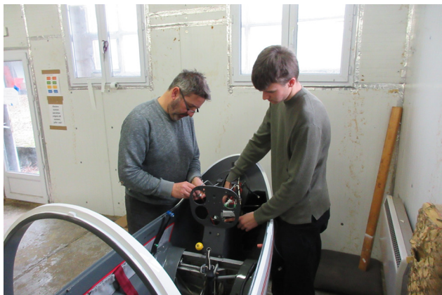
ERWIN EN ANDRIK INSTALLEREN EEN NIEUW INSTRUMENTENBORD IN DE TWIN II
